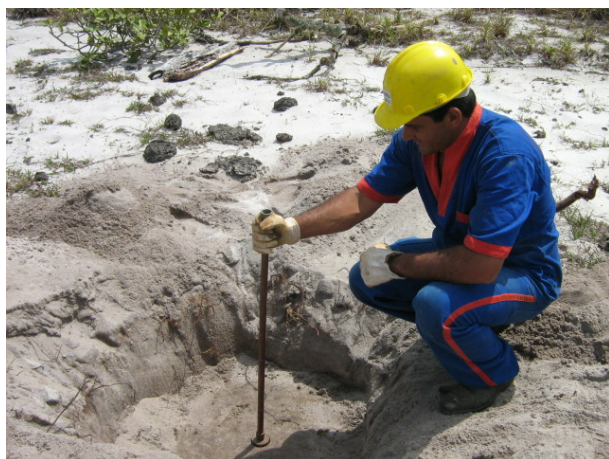
Foto 5.3.5.1.1-5 - Coleta de amostra indeformada em trincheira.
