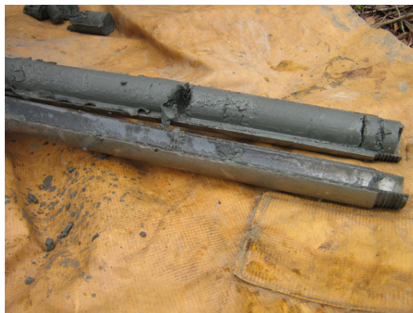
Foto 5.3.5.3.1-2: Argila siltosa plástica, orgânica, de coloração cinza escura (Camada C), obtida no barrilete amostrador da sondagem a percussão.
