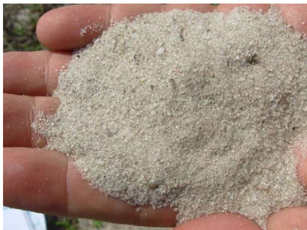
Foto 5.3.5.3.1-1: Areia fina a grossa esbranquiçada, com grãos bem arredondados, da camada superficial (Camada A). A alta esfericidade de alguns grãos é indicadora de contribuição eólica no transporte destes sedimentos.
